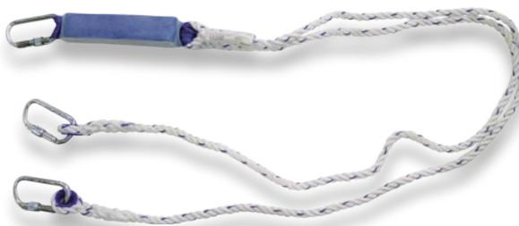
**Questo elemento deve includere sempre un dispositivo di assorbimento dell'energia per garantire l'arresto senza danni fisici per l'utilizzatore) l'impatto in caso di caduta dovrà essere inferiore ai 600 daN**
