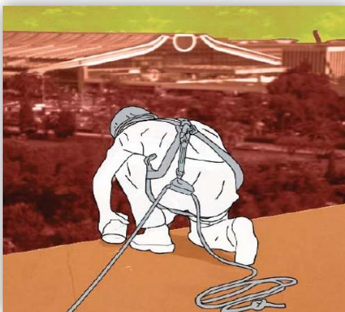
Il dispositivo di scorrimento e d'arresto viene prodotto in diverse tipologie (automatico o semiautomatico) permette all'operatore una volta collegato con un connettore al punto di ancoraggio di raggiungere la zona di lavoro (coperture – tetti inclinati) e di potersi muovere con una certa libertà grazie alla FUNE di collegamento.
